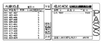
8761NAK 提供斷短路測試檢查整個迴路的狀態
