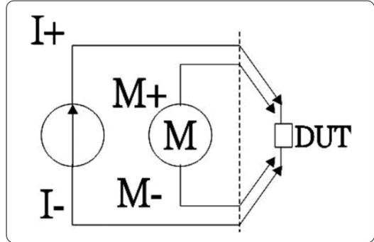
8761 採取四線量測技術，直接連接至待測線束之兩端進行量測，避免整體接線產生的誤差，使量測阻抗更精密，達到低阻 1mΩ。
